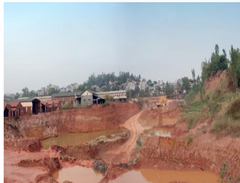
Đất sét – nguyên liệu chính để sản xuất gạch ngói được VHL khai thác ở khu vực Giếng Đáy.
